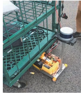
牽引型移動ロボット (2モータ, 1キャスト構造)
